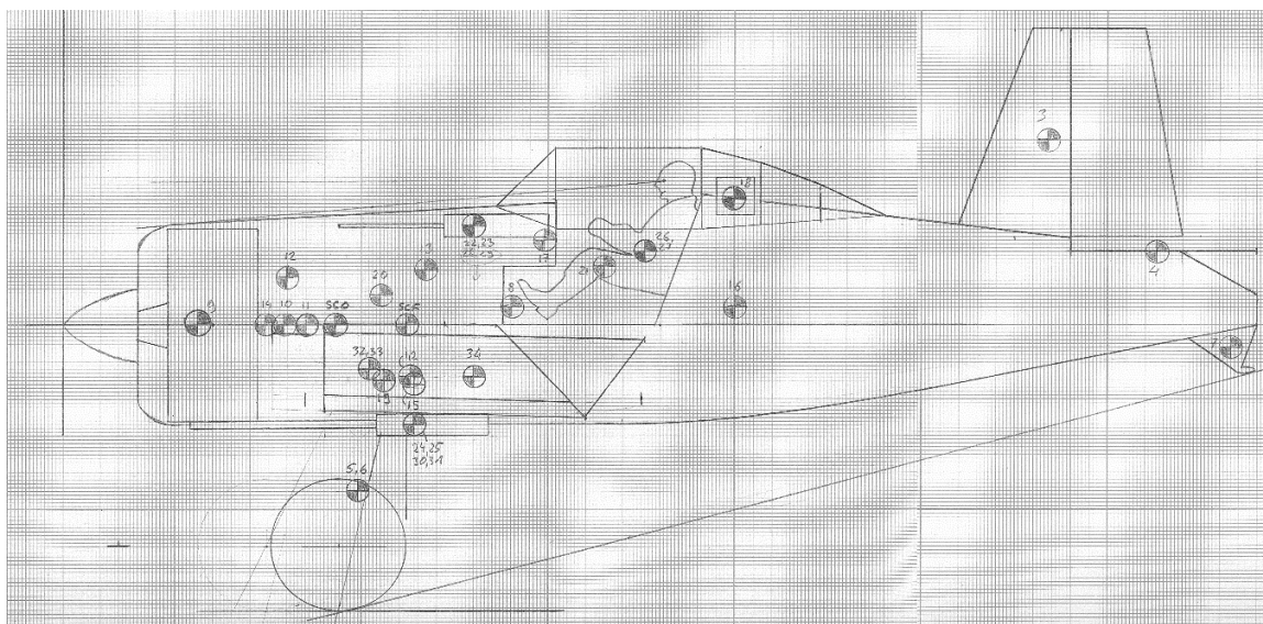
Rys. 2 arkusz wyważenia samolotu po modyfikacji
