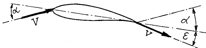
Rys. 7.7 Kąt odchylenia strug za skrzydłem
