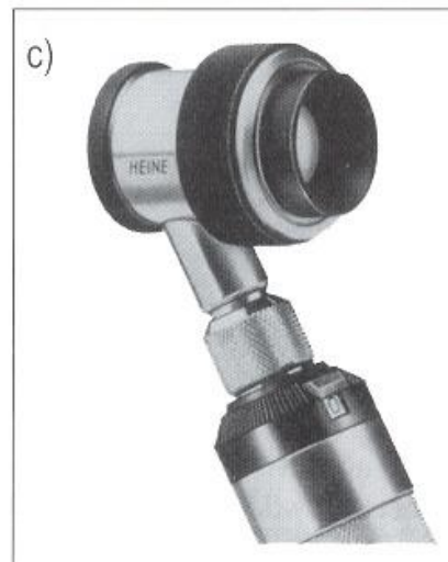
Drobne wyposażenie do badań wizualnych: a) lupy, mikroskopy piórowe (u dołu) i mikroskopy pomiarowe (w środku), b) skale do lup i mikroskopów do badań wizualnych, c) lupa z oświetlaczem i skalą, firmy Heine. Za zgodą firmy Heine.
