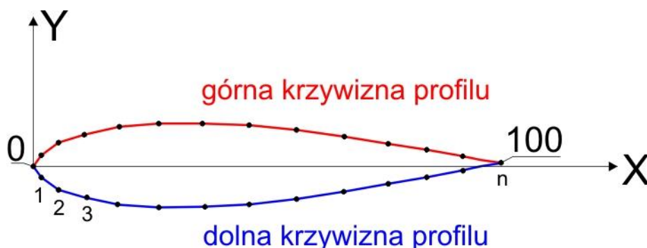
Rys. 3.2 – Definicja zbioru *.prf opisującego geometrię danego profilu skrzydła
